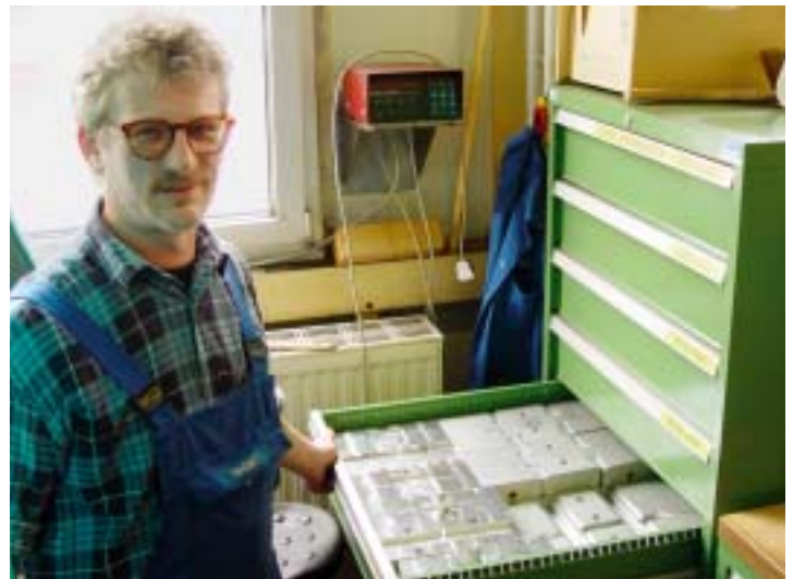
1 Hat keine »Vorrichtungsleichen« im Keller: Facharbeiter Michael Raquet hat etwa 60 werkstückspezifische Backensätze jederzeit griffbereit; die Teilekontur wird einfach in die Backen eingefräst
