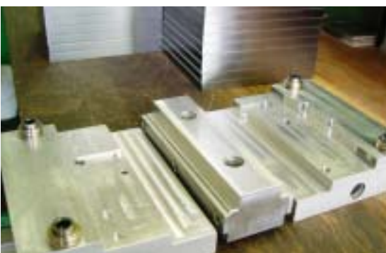
4 Auch für harte Fälle: Die Backensätze aus Aluminium sind auch für Zerspanungsaufgaben in Stahl oder Edelstahl geeignet und ermöglichen eine Mehrseitenbearbeitung
